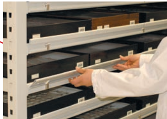
標本棚には、落下防止のストッパーを取付けています。
