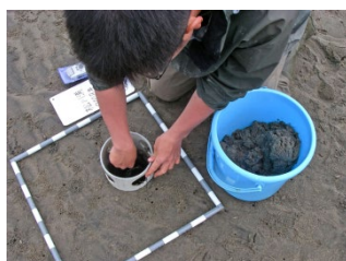
5. 深さ 20 cm までの底土を掘り取る
