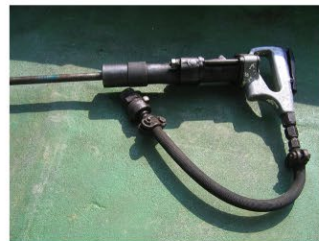
3. ハンマードリル (岩盤を穿孔する)
