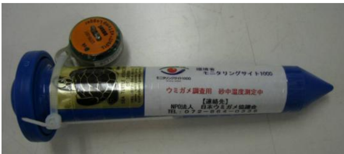
図 3-2. データロガーを水道管工事用マーカースと結合した状態
