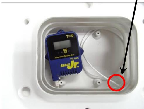
注) おんどとりのセンサー部(赤丸部)が通風シェルターに接触すると、冬期にシェルターとセンサー部の間に雪氷が付着する事がある。その為、センサー部をシェルターから離して空中になるように固定する。
