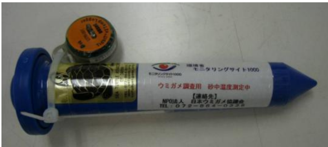
図 3-2. データロガーを水道管工事用マーカーと結合した状態
