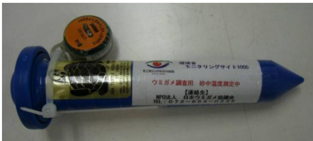
図3-1. データロガーを水道管工事用マーカースと結合した状態
