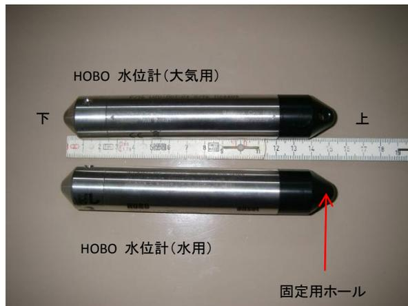
図 8. 水位計に使用するデータロガー.
