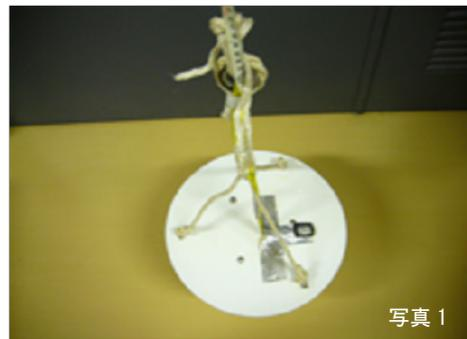
ロープに 1 cm 刻みで目盛りが付いていれば、そのまま透明度を読み取ることができる。目盛りが付いていない場合、10 cm、50 cm、1 m、5 m 毎に異なる印の目盛りを付けておき、10 cm 単位まで読み取る。測定した透明度を記録する際の単位は m を用い、小数点以下第一位までを調査票に記録する。
