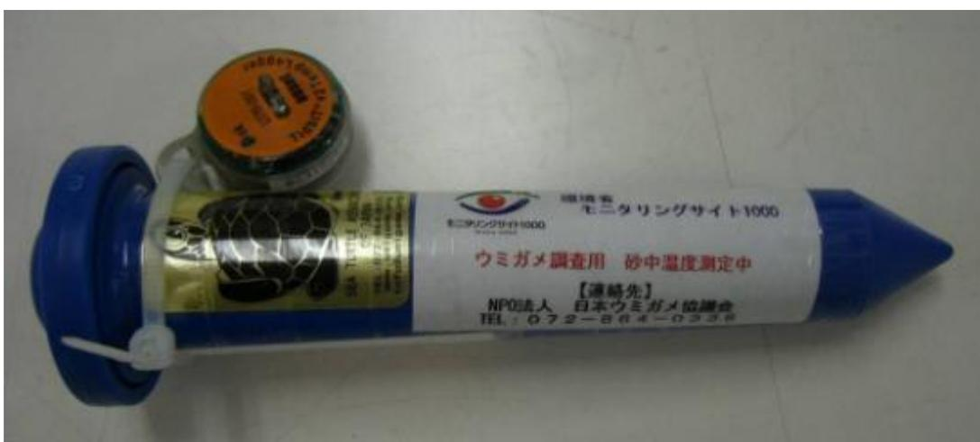
図3-1. データロガーを水道管工事用マーカーと結合した状態
