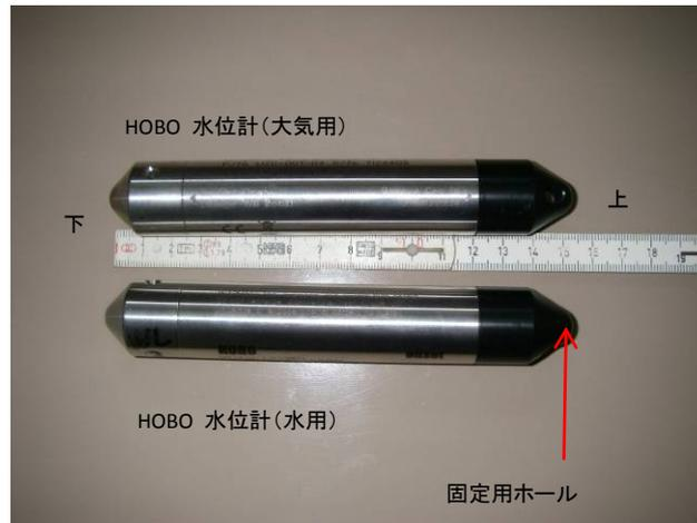
図 9. 水位計に使用するデータロガー
