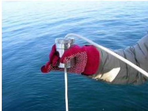
メッセンジャーが湖底に着いて採泥器上部にぶつかり、その反動で金具がはずれ、採泥器の底部が閉まり始める。採泥器の底部が完全に閉まるのにしばらく時間がかかる（採取する泥の堅さや圧密度によって閉まる時間が違う）。2～3 分待つてから（水深が浅い場合は、湖底から細かい気泡が出るが見えるので、気泡が消えるまで待つ）、ゆっくりロープを持ち上げる。採泥器が泥から抜けると、スッと軽くなる。ゆっくりで良いので、できるだけ
