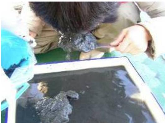
底泥の色を色見本で識別し、記録する。また、手で泥を少しつまんで底質区分（礫・砂礫・砂・砂泥・泥）も記録する。（船上での作業が難しいときは、できるだけ速やかに陸に移動して上記の作業を行っても良い。ただし、泥温だけは、現場で採泥器の上部のフタを開け、そこから温度計を挿入して測定しておく）
