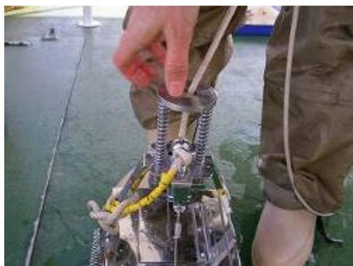
ロープを伸ばし、底が開いた状態の採泥器をまっすぐ静かに湖底に下ろす（写真左）。採泥器が底につくとロープが緩むので、ロープにテンションをかけて真っ直ぐに伸ばし、船上でメッセンジャーの溝をロープに挟み込み、90 度回して固定する。ロープにテンションをかけたまま、メッセンジャーから手を離す（写真右）。（風波で船が流されてロープが斜めになっていると、メッセンジャーがうまく作動せず、失敗することが多い。）
