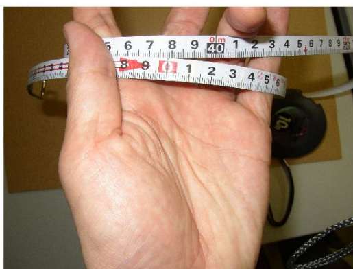
図8 スチールメジャーの読み取り方. 上の写真の場合、37.8cm と読む。
