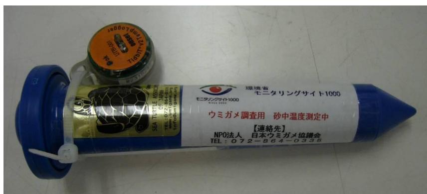
写真 1 ロガーを水道管工事用マーカーと結合した状態
