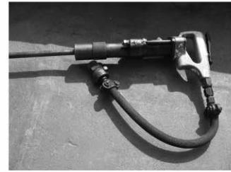
3. ハンマードリル (岩盤を穿孔する)
