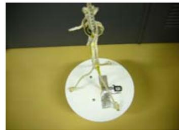
ロープに1cm刻みで目盛りが付いていれば、そのまま透明度を読み取ることができる。目盛りが付いていない場合、10cm, 50cm, 1m, 5m 毎に異なる印により目盛りを付けておき、10cm 単位まで読み取る。測定した透明度を記録する際の単位は m を用い、小数点以下第一位までを調査票に記録する。
