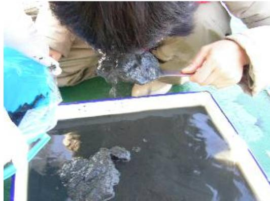
底泥の色を色見本で識別し、記録する。また、手で泥を少しつまんで底質区分（レキ，砂礫，砂，砂泥，泥）も記録する。（船上での作業が難しいときは，できるだけ速やかに陸に移動して上記の作業を行っても良い。ただし，泥温だけは，現場で採泥器の上部のフタを開け，そこから温度計を挿入して測定しておく）
