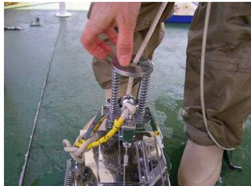
ロープを伸ばし、底が開いた状態の採泥器をまっすぐ静かに湖底に下ろす（次頁写真左）。採泥器が底につくとロープが緩むので、ロープにテンションをかけて真っ直ぐに伸ばし、船上でメッセンジャーの溝をロープに挟み込み、90 度回して固定する。ロープにテンションをかけたまま、メッセンジャーから手を離す（次頁写真右）。（風で船が流されるなどでロープが斜めになっていると、メッセンジャーがうまく作動せず、失敗することが多い。）
