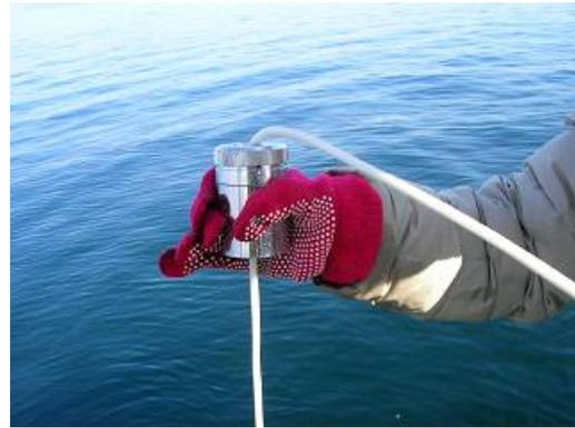
メッセンジャーが湖底に着いて採泥器上部にぶつかると、その反動で金具がはずれ、採泥器の底が閉まり始める。底が完全に閉まるのにしばらく時間がかかる（泥の堅さや圧密度によって閉まる時間が違う）。（水深が浅い場合は、湖底から細かい泡が出るので泡が消えるまで待つ）2-3分待ってから、ゆっくりロープを持ち上げる。採泥器が泥から抜けると、スッと軽くなる。ゆっくりで良いので、できるだけ一定のスピードでロープを引っ張りあげ、採泥器を船上まで引き上げる。
