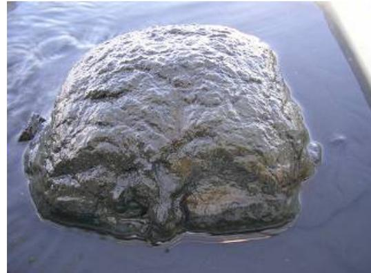
温度計を表面泥に突き刺して、泥温を測定する（写真次頁左）。日光があたったり、外気温が高かったり、低かったりすると泥温が急速に上下するため、速やかに泥温を測定すること。次に、物差しで泥厚（mm）を測る。
