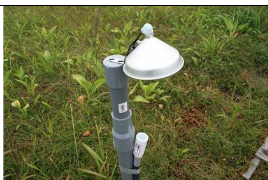
設置した温度計（2009年8月13日）
