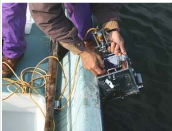
採泥器による底生動物の調査. 宍道湖 (2008.11.27)
