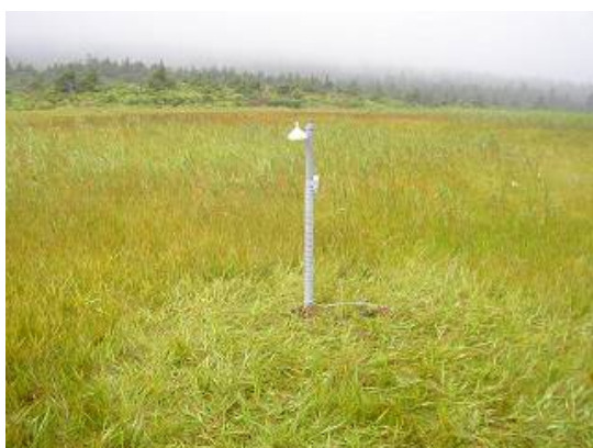
気温計と地温計を兼ねた水位計
