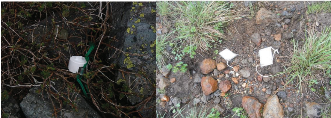
温度ロガーの設置方法の例(右写真の撮影：白山自然保護センター)
