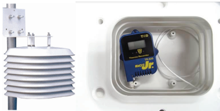
写真 左：通風シェルター CO-RS1、右：同シェルター内へのおんどり Jr の設置例
