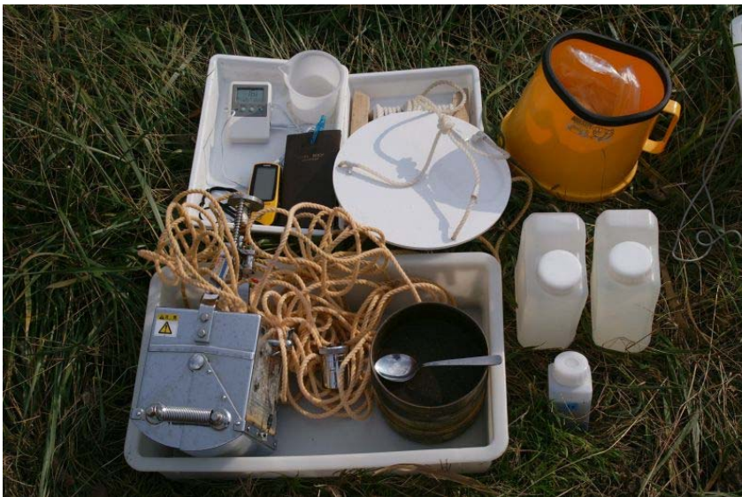
写真：央道湖で乗船調査に用いた道具（底生生物調査、透明度、水温、採水）
