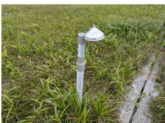
気温計測用の設置機器の様子
