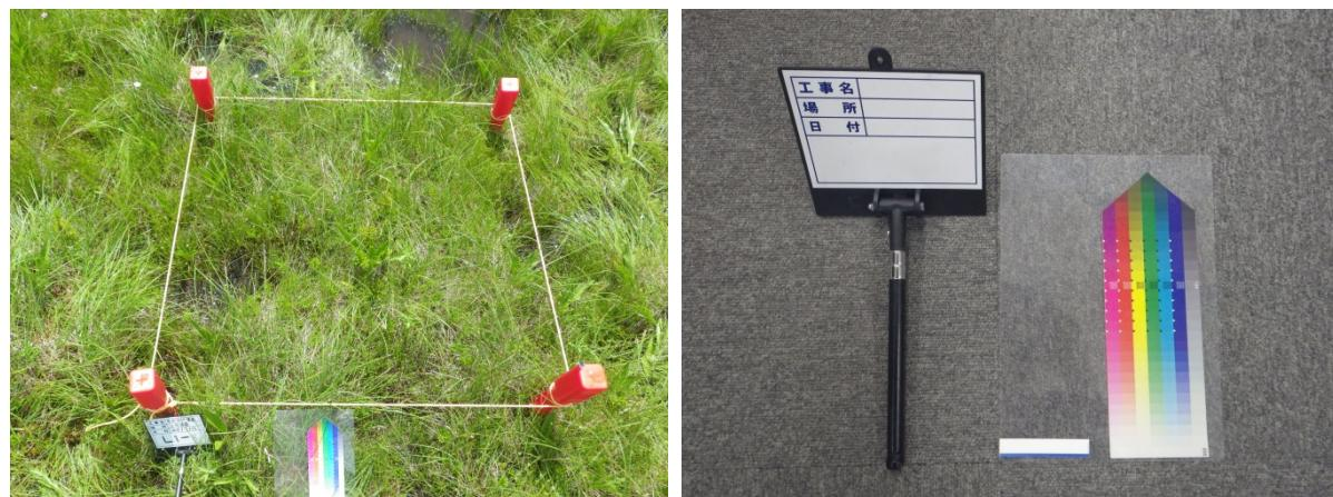
図. 方形区の写真撮影。進行方向に向かって左下の杭付近にラベルを配置して撮影(左)。
