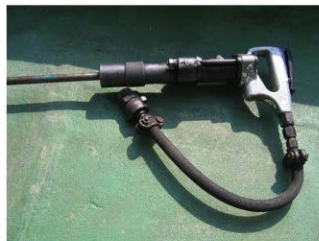
3. ハンマードリル (岩盤を穿孔する)
