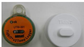
温度ロガー： StowAway Tidbit v2 (左) とブーツ (右)
