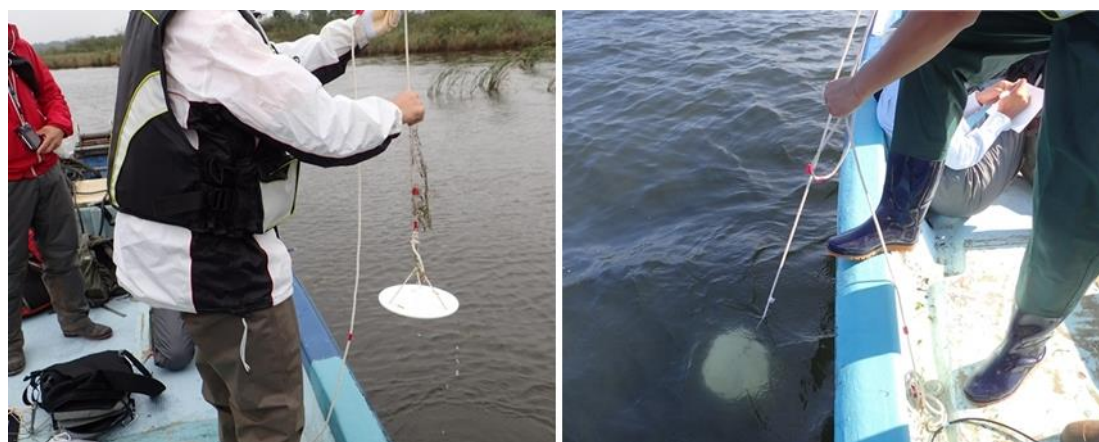
図. 水質測定の様子（透明度板を用いた透明度測定）
