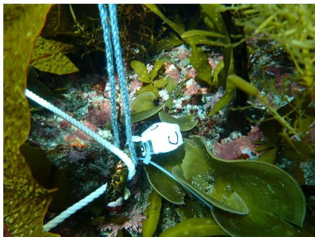
15 永久方形枠 F の位置を示すアンカーボルトと水温データロガー。
