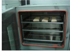
5. 60℃で乾燥させ、乾燥重量を計測する
