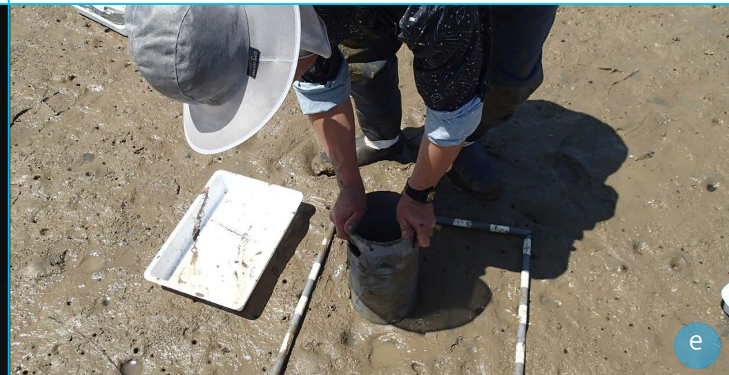
▲ 定量調査の様子。方形枠内にコアサンプラーを差し込み、底泥中に生息する動物をサンプリングします。
