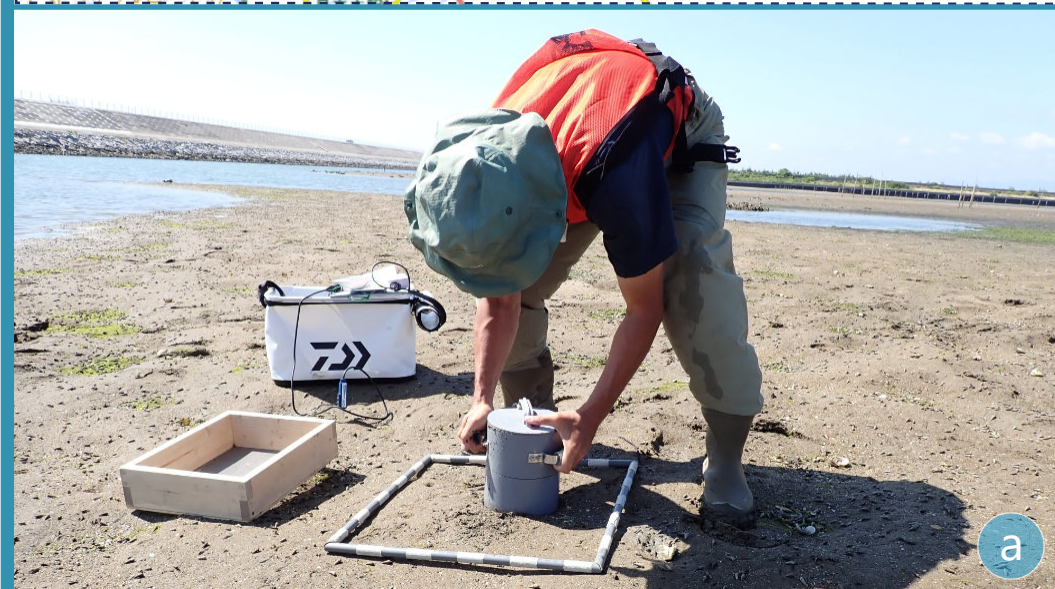
▲ 調査の様子：Aエリアの潮間帯上部で、毎年の定量的な調査をしているところです。干潟上に決まった大きさの筒を差し込んで泥を採取し、2ミリ目合のふるいにかけて、ふるいの上に残った動物を同定し、種ごとに個体数を計数します。
