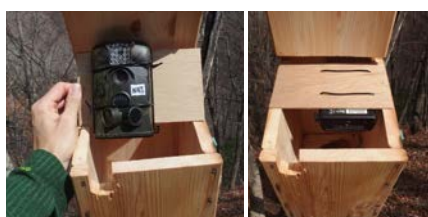
図1 巣箱に設置したトレイルカメラ。レンズから巣までの距離が短いので、近くでもピン트가合うようレンズに細工をしている。
