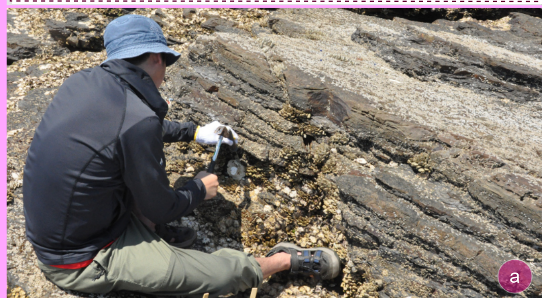
▲ 調査の様子：温度を自動計測する機器（温度データロガー）の交換を行っています。温度データロガーは、水中ボンドを土台として岩に固定しており、土台の水中ボンドごと岩から剥がして回収し、新しい機器を取り付けます。
