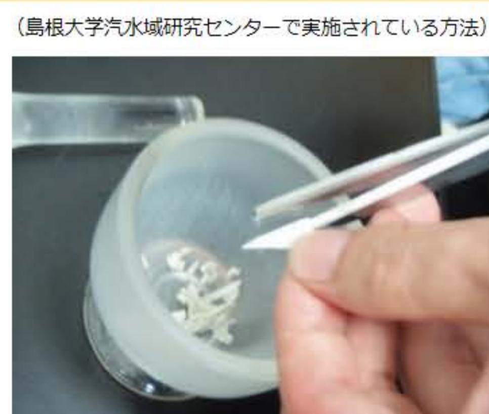
1) プランクトンをろ過したろ紙をはさみで小片に切り刻む
