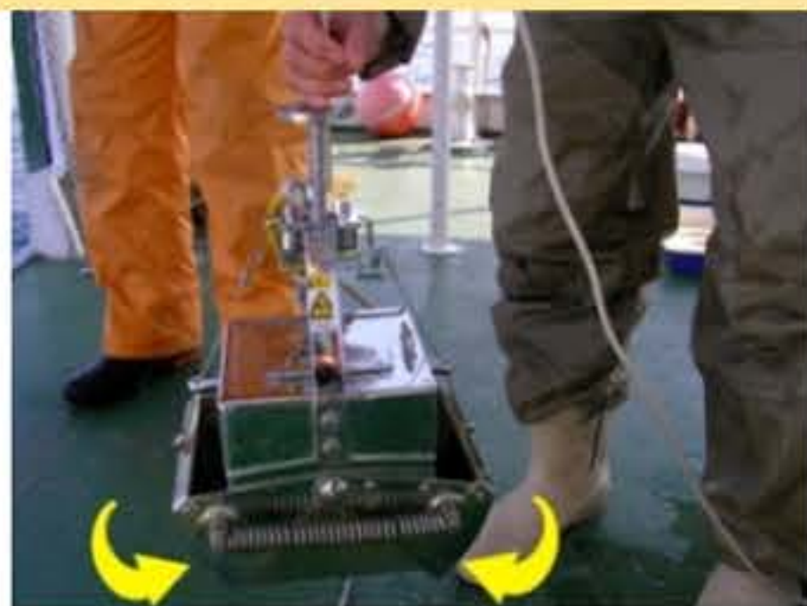
エクマン・バージ採泥器 （底の開口部が、湖底で矢印のように閉まる）
