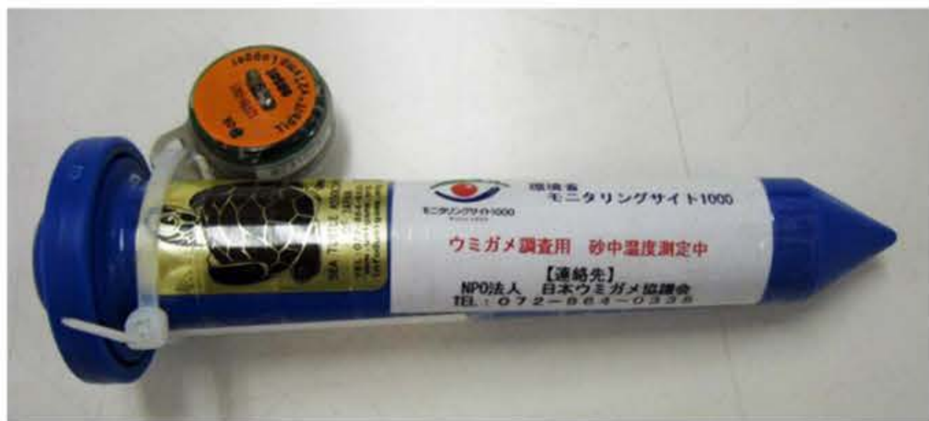
写真 砂浜に埋める温度ロガー（オレンジ）と、探知機で探し出すための水道マーカ―（青）
