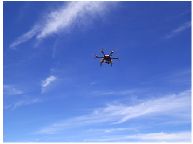
写真2. 6枚のプロペラを持つラジコンヘリコプター (GrassHopper)。
