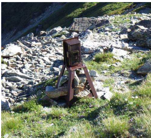
南アルプスの北岳で設置しているインターバルカメラ、転倒し難い構造に改良した
