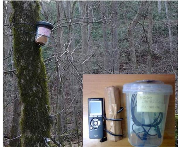
調査地に設置した自動録音装置と、録音装置の内容。録音装置の詳細は、左から ICレコーダー、単一電池、防水ケース。
