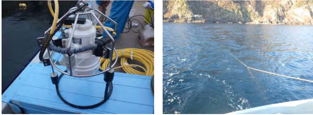
図 I.3-2 水中ビデオカメラ（例）の外観（写真左）と曳航の状況（写真右）
