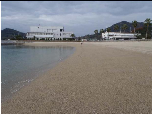
No.19：今治市伯方島<sup>うてな</sup>）汀線勾配 1/8、底質は薄黄色の小礫混じり中砂。砂浜幅は約 35m。突堤で囲まれた海岸。
