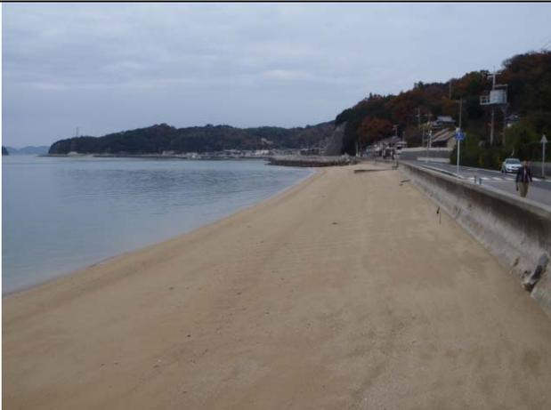
No.21 : 今治市大島吉海) 汀線勾配 1/10、底質は薄黄色の粗砂。砂浜幅は約 30m。砂浜に植生は未発達。
