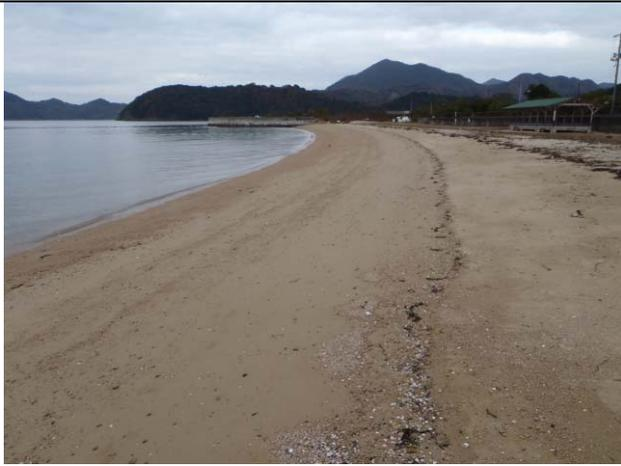
No.17：今治市大三島<sup>うてな</sup>（台）汀線勾配 1/8、底質は薄黄色の中砂。砂浜幅は約 25m。突堤と離岸堤で囲まれた海岸。
