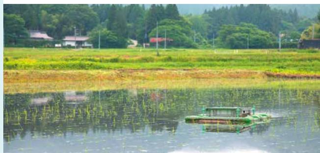
① アイガモロボット 泥を巻き上げて、草の発生を抑制するロボット
