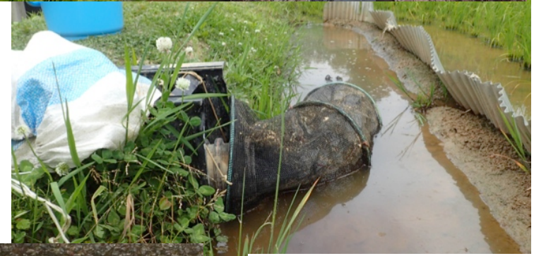
ドジョウの遡上数を調べるために魚道の出口に設置した網
