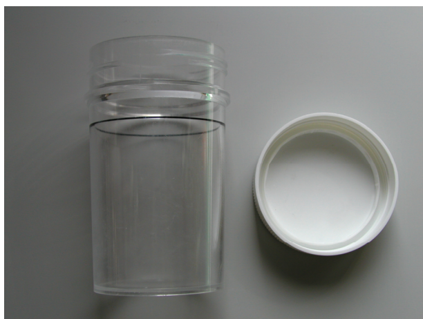
写真 1-3 定期採集に用いたスチロール T 型瓶
