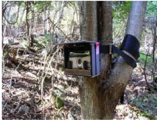
写真1 赤外線センサーカメラ
