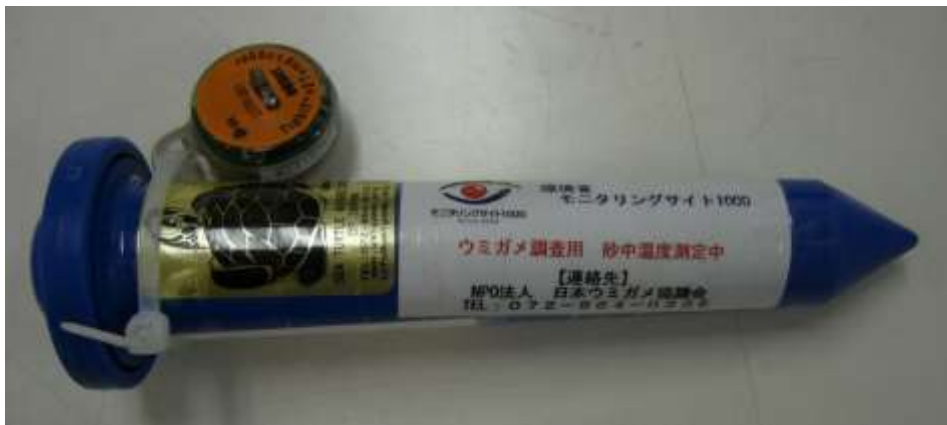
水道管工事用マーカー（青）に結束した温度データロガー（オレンジ）
