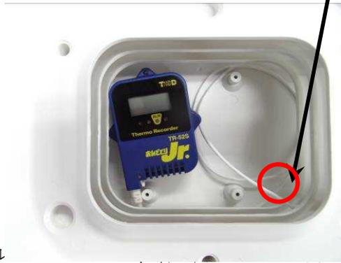
注) おんどとりのセンサー部（赤丸部）が通風シェルターに接触すると、冬期にシェルターとセンサー部の間に雪氷が付着する事がある。その為、センサー部をシェルターから離して空中になるように固定する。
