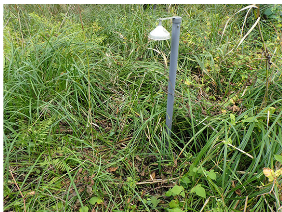
湿原内に設置した水位管
