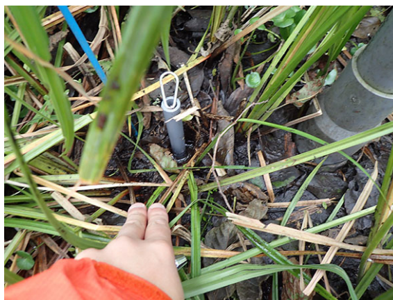
地中に埋設した温度計
