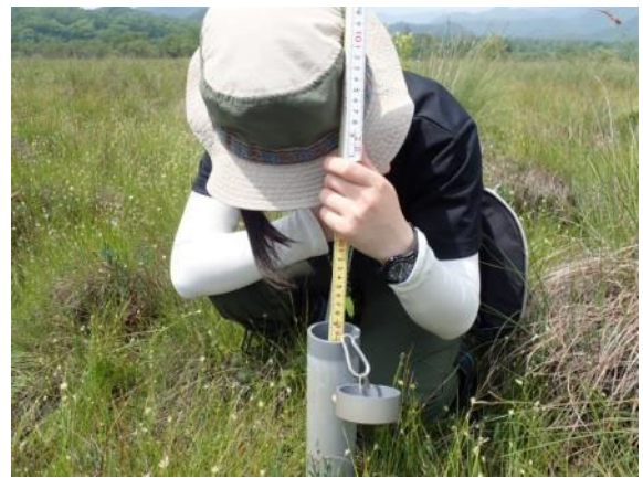
水圧計が設置されているパイプ内の地下水位 を実測する様子
