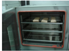
5. 60°Cで乾燥させ、乾燥重量を計測する
