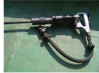
3. ハンマードリル (岩盤を穿孔する)
