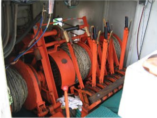
1. ウィンチ (機材を上下運搬する)
