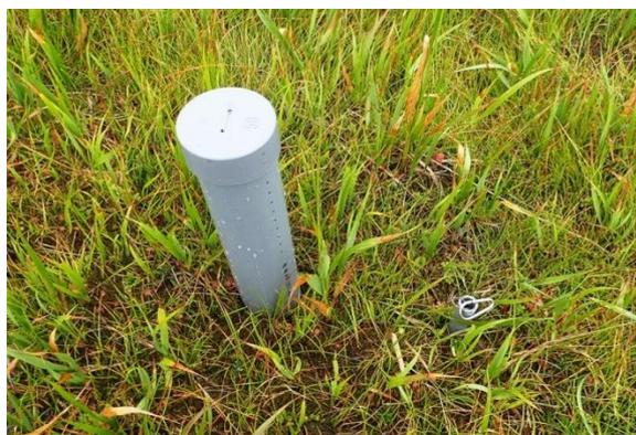
地下水位計パイプ (左) と地温計パイプ (右)
