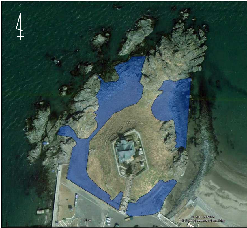
図 4-3-2 蕪島全体図、青は 2011 年 3 月 11 日の津波により冠水した箇所 (Google Earth を使用)
