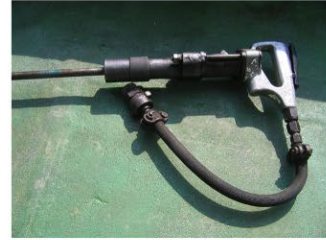
3. ハンマードリル (岩盤を穿孔する)
