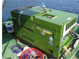
2. エアーマン (岩盤の穿孔作業 に必要なエアを送る)
