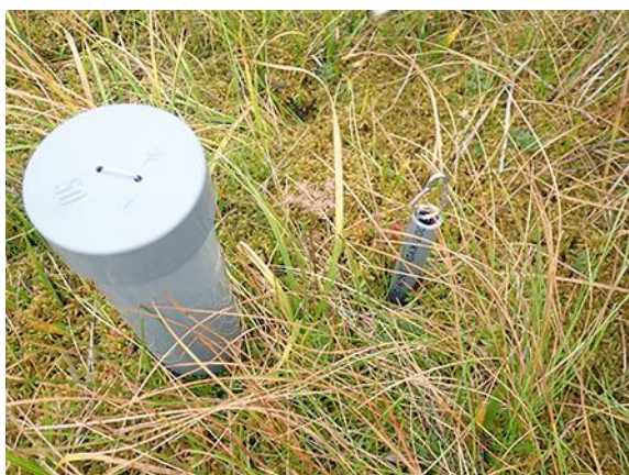
地下水位計パイプ（左）と 地温計パイプ（右）（八幡沼湿原）
