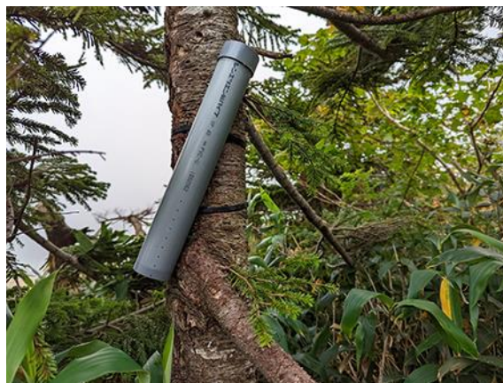
樹上に設置した気温計パイプ （八幡沼湿原）
