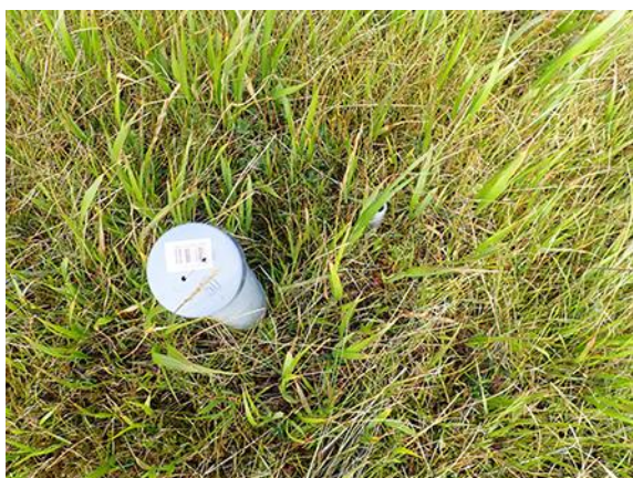
地下水位計パイプ（左）と 地温計パイプ（右）（黒谷地湿原）
