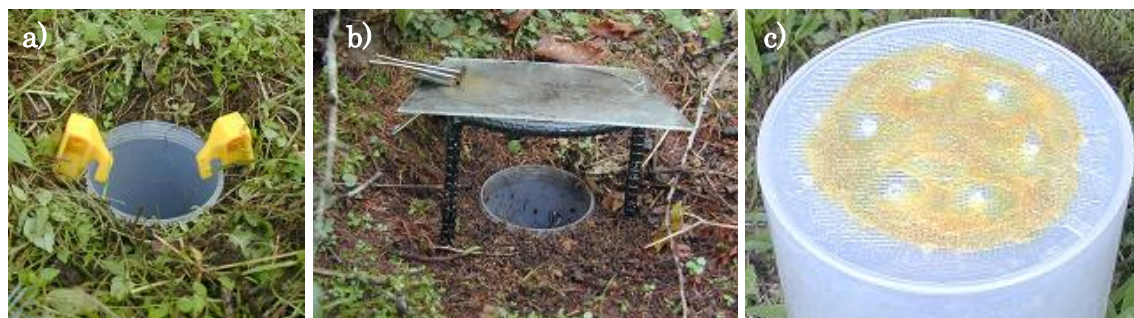
図 3. トラップの設置・加工例. a) ペグを用いたトラップの固定. b) 雨よけの設置例. c) 底面の加工例. 大きい水抜き穴を 6ヶ所開け、穴を覆うように目開き 1mm の網を接着している.
