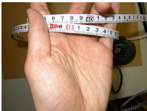
図8 スチールメジャーの読み取り方. 上の写真の場合、37.8cmと読む。
