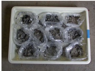
5. 60°Cで3日間乾燥させて保管する。または分析項目ごとにサンプルをシール付ポリ袋等に分け、冷蔵・冷凍して保管する。
