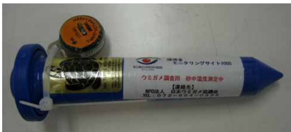
写真 水道管工事用マーカー（青）に結束した温度データロガー（オレンジ）
