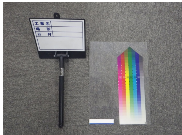
図. 方形区の写真撮影. 進行方向に向かって左下の杭付近にラベルを配置して撮影(左). ラベルと色見本を兼ねた矢印板(右).
