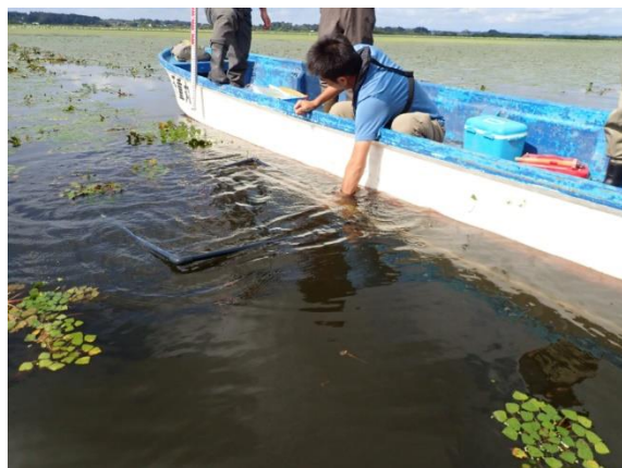
植生断面調査： 方形枠内の水生植物を記録する様子
