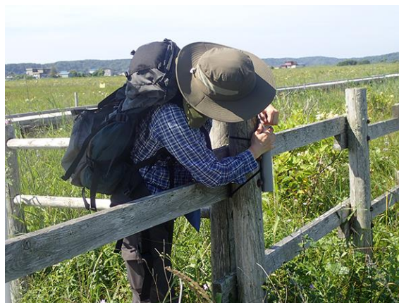
気圧計を回収・交換する様子 （撮影：内田暁友）
